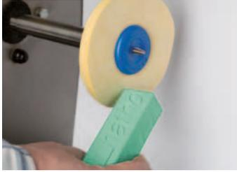
La surface métallique ainsi préparée de façon optimale pour le lustrage se traite à présent à l'aide d'un disque en chamois de microfibres (art n° 520 100/7) à 1.400 tours/min. Avec les alliages au CrCoMo on obtient les meilleurs résultats en utilisant la pâte à polir Polistar Vert. Le matériau doux absorbe très bien la pâte et la restitue peu à peu lors de l'opération de polissage.
