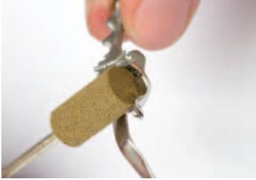
Pour effectuer le pré-polissage et le finissage on utilise les meules sur tige HATHOfex S plus P. Leur combinaison particulièrement bien équilibrée d'abrasif (corindon) et d'agglomérant de haute qualité ainsi que leur proportion exceptionnelle d'abrasif (60 %) permettent d'obtenir une bonne érosion et une surface lisse même avec les alliages d'armatures extrêmement durs. La meule sur tige cylindrique (art n° 202 8 HP) a fait ses preuves dans la retouche des crochets et l'ajustement palatin.
