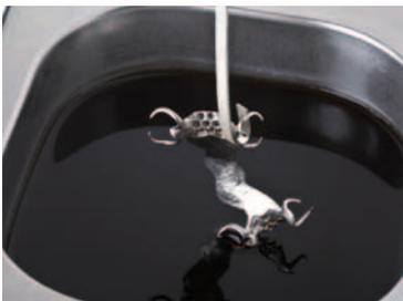
Pour donner ce qu'on appelle le "poli" dans un bain électrolytique, on égalise la surface par érosion électrochimique. L'armature coulée sert alors d'anode et cède continuellement des ions métalliques à la solution électrolytique. En raison de leur plus grande surface, les aspérités s'usent plus vite et s'aplanissent donc par rapport à leur voisin. Il en résulte une égalisation du relief.
