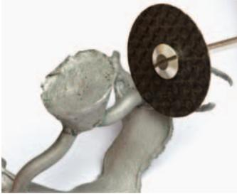
Après le refroidissement, on enlève avec précaution le matériau d'enrobage de l'objet coulé à l'aide d'une pince à plâtre. On élimine les résidus mineurs adhérent à la surface par décapage au sablage. À présent on peut couper les tiges de coulée avec un disque à tronçonner renforcé de toile et en meuler les traces résiduelles.
