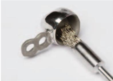
On élimine les perles de coulée éventuellement présentes sur la surface intérieure des couronnes coniques en alliage au CrCoMo, et on lui donne un brillant mat, à l'aide d'une brosse pinceau miniature en fil d'acier ondulé (art n° 193 p8 HP). Les brosses miniatures pinceaux s'utilisent toujours à des vitesses allant de 5.000 à 10.000 tours/min.
