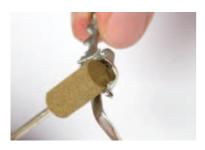
Zum Feinschliff und zur Vorpolitur werden die HATHOfex S plus P Polierer eingesetzt. Ihre besonders aufeinander abgestimmte Kombination aus Schleifmittel (Korund) und hochwertigem Trägermaterial, sowie der ungewöhnlich hohe Schleifmittelanteil (60%) ermöglichen auch bei extrem harten Modellgusslegierungen einen guten Abtrag und eine glatte Oberfläche.
