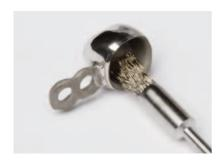
Bei Konuskronen aus CrCoMo-Legierung wird die Innenfläche mit einer Mini-Endbürste aus gewelltem Stahldraht (Art.Nr. 193 p8 HP) von evtl. Gussperlen befreit und auf Mattglanz poliert. Mini-Endbürsten werden immer mit Drehzahlen zwischen 5.000 - 10.000 min<sup>-1</sup> eingesetzt.
