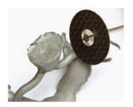
Nach dem Abkühlen wird die Einbettmasse mit Hilfe einer Ausbettzange vorsichtig vom Gussobjekt entfernt. Kleinere Reste auf der Oberfläche werden durch Sandstrahlen beseitigt.
