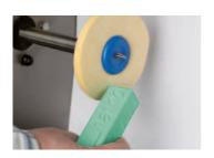
Die nun optimal für die Hochglanzpolitur vorbereitete Metalloberfläche wird mit einer Schwabbel aus Mikrofaser-Leder (Art.Nr. 520 100/7) bei 1.400 min -1 weiter bearbeitet. Mit der Polierpaste Polistar Grün lassen sich bei CrCoMo-Legierungen die besten Ergebnisse erzielen. Die Paste wird effektiv von dem weichen Material der Schwabbel aufgenommen und nach und nach beim Poliervorgang abgegeben.
