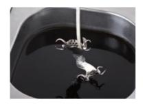
Beim sogenannten "Glänzen" im Elektrolytbad wird nun die Oberfläche durch galvanischen Abtrag geglättet. Dabei wirkt das Modellgussobjekt als Anode und gibt kontinuierlich Metallionen in die Elektrolytlösung ab. Unebenheiten werden aufgrund ihrer größeren Oberfläche stärker abgetragen und deshalb im Verhältnis zu ihrer Umgebung eingeebnet. Dies führt zu einer Angleichung des Reliefs.
