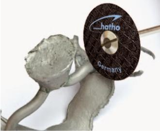
Después del enfriamiento se quita cuidadosamente el material de inclusión del objeto de fundición por medio de pinzas de extracción. Los residuos menores adheriendo a la superficie se limpian por chorro de arena. Ahora se pueden separar las mazarotas por medio de una muela de tronzar reforzada por tejido, después se remueven esmerilandolas (Ref. 654 40x05 H).
