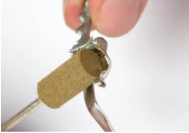
Para el esmerilado y el prepulido se utilizan las muelas pulidoras HATHOfex S más P. Su combinación muy bien ajustada de abrasivo (corindón) y material de base de alta calidad así como su excepcional proporción de abrasivo (60 %) permiten obtener una buena erosión y una superficie lisa incluso con las aleaciones de armazones sumamente duras. La muela pulidora cilíndrica (Ref. 202 8 HP) ha demostrado su eficacia en el retoque de las fijaciones y del ajuste palatino.
