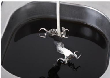
Para dar el llamado “brillo” en baño electrolítico, se alisa ahora la superficie por erosión galvánica. Al hacer eso, el objeto que es el armazón sirve de ánodo y libera continuamente unos iones metálicos en la solución electrolítica. Las asperezas se desgatan más fuerte en virtud de su superficie más grande, y por eso se aplanan en comparación a su vecindad. El relieve se uniforma.
