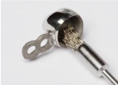
La superficie interior de las coronas cónicas en aleación de CrCoMo se libra de las perlas de fundición eventuales y se pule a brillo mate por medio de un cepillo pincel de alambre de acero ondulado (Ref. 193 p8 HP). Las microcepillos pinceles siempre se utilizan a velocidades de 5.000 a 10.000 min-1.
