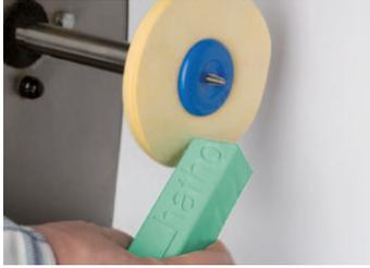
La superficie metálica así preparada de modo óptimo para el abrillantado se trabaja ahora con la ayuda de un disco de paño en cuero de microfibras (Ref. 520 100/7) a 1.400 min<sup>-1</sup>. En las aleaciones de CrCoMo los mejores resultados se obtienen con la pasta de pulir Polistar Verde. El material blando del disco absorbe la pasta en gran cantidad y la libra poco a poco durante la operación de pulido.
