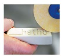
La superficie de la prótesis tiene ahora un aspecto liso uniforme y está lista para el pulido. A este efecto se utiliza la pasta para el abrillantado desarrollada especialmente para los plásticos de prótesis ( Polistar beige ).
