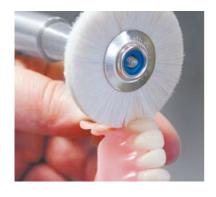
El cepillo de pelo de cabra (Ref. 100 48) alcanza los puntos de difícil acceso tales como las zonas interdentales, las partes profundas del paladar y la transición metal/plástico de las prótesis parciales. Para evitar un desarrollo de calor se recomienda aquí también una velocidad reducida de 1400 vueltas/min. Ahora la superficie de plástico está lista para la última fase de trabajo, el abrillantado.
